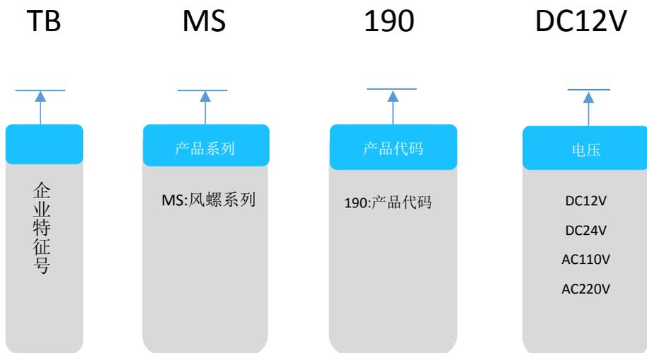
例如：MS190 AC220V,代表风螺报警器 190 系列，额定工作电压为 AC220V，安装方式为螺丝安装，
